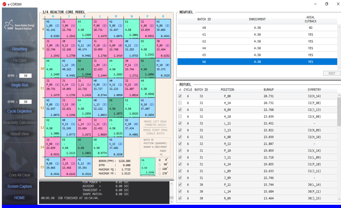
Hình 5: Cách sắp xếp bó thanh nhiên liệu được sử dụng để mô phỏng
