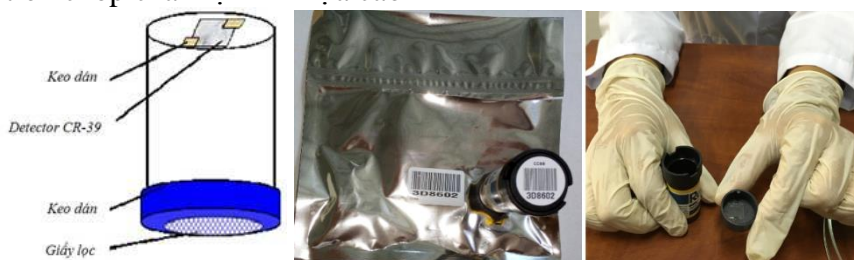
Hình 2: Cấu tạo mẫu detector CR39
