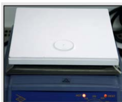
Hình 5: Nhỏ mẫu trên vật liệu mang mẫu và sấy mẫu
